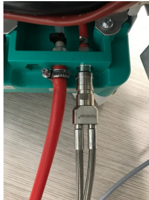
SECONDARY LOOP PER IL COLLEGAMENTO DIRETTO AL MONITOR DI DIALISI
